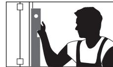
Positionner l'encadrement de porte à la verticale et à l'horizontale à l'aide d'un niveau à bulle.
