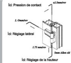
En cas de problème pour fermer la porte, veuillez ajuster en utilisant ce schéma
