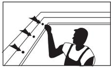
Repérer les emplacements pour les perçages de cheville, à une distance minimale d'au moins 15 cm du coin et un écart max de 50 cm entre chaque perçage.
