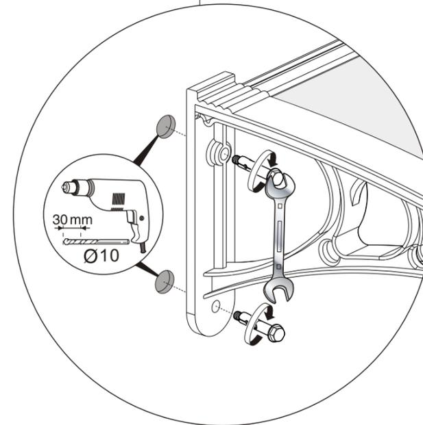
Percer avec une mèche adaptée Ø10 le mur puis fixer la marquise avec les ancrages adaptés.
