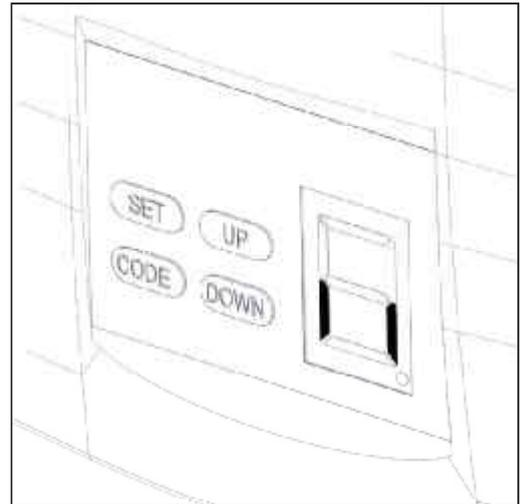
Appuyer sur le bouton « CODE » jusqu'à ce que s'allume le point.
