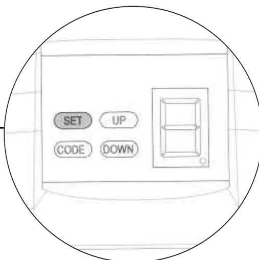
Fermeture: Appuyer sur le bouton « SET » jusqu'à ce qu'apparaisse le chiffre 2.
