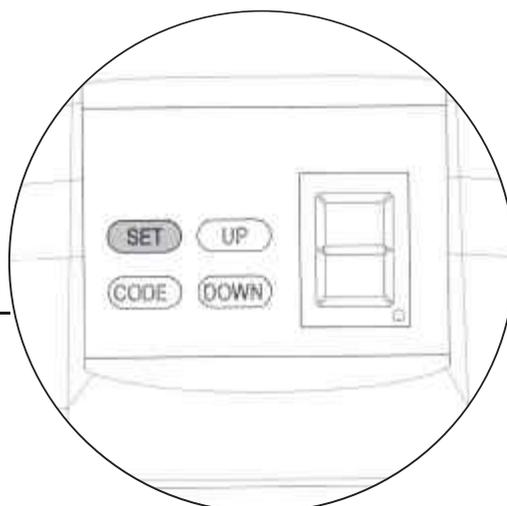
Ouverture: Appuyer sur le bouton « SET » jusqu'à ce qu'apparaisse le chiffre 1.
