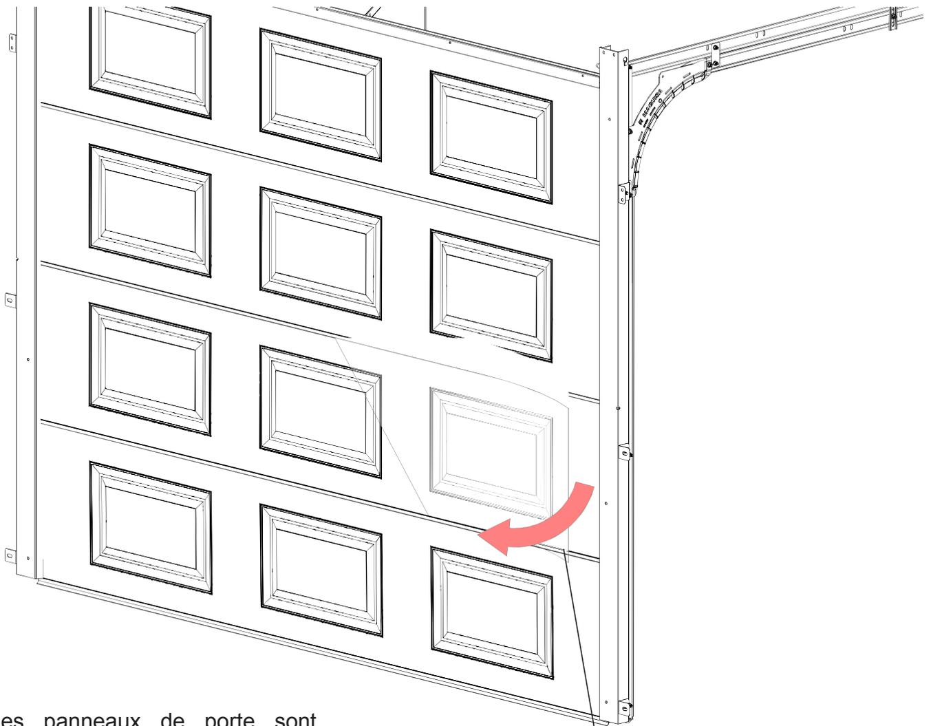
Les panneaux de porte sont recouverts à l'extérieur et à l'intérieur d'un film transparent de protection.
