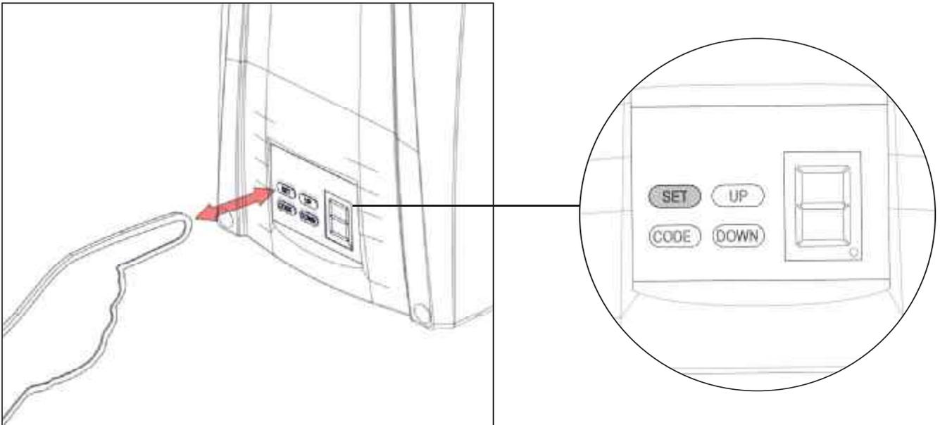
Appuyer sur SET. Le moteur effectuera automatiquement un cycle ouverture et fermeture pour enregistrer les positions finales et déterminer automatiquement la force de traction du moteur.
