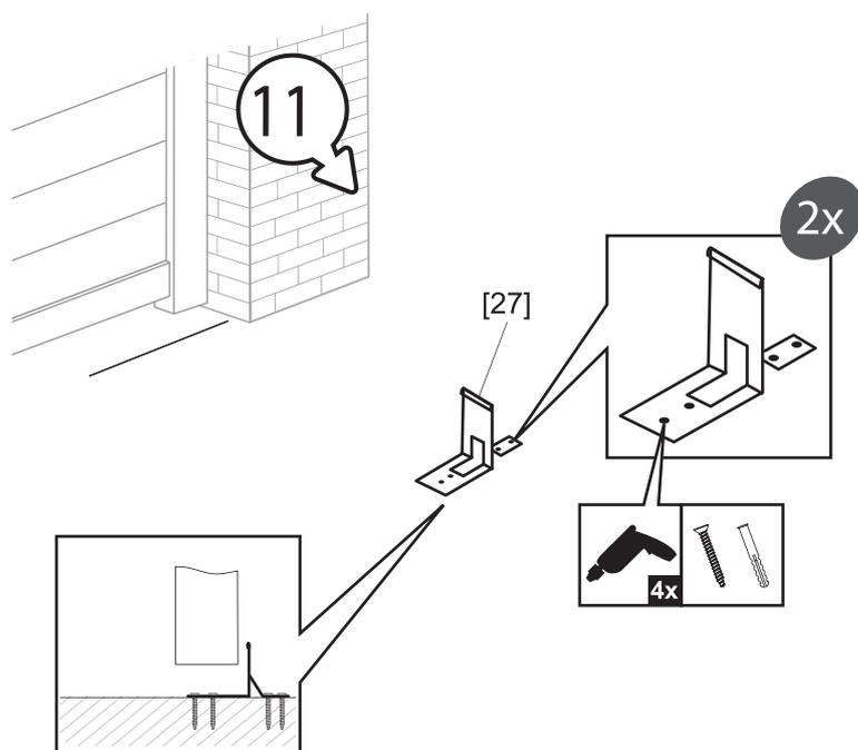
Veuillez positionner correctement les butées (pièces n°27) afin de ne pas endommager le portail et/ou le moteur.
