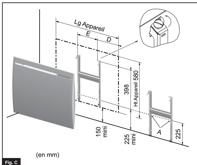
*Conseil : Pour faciliter l'obtention de la cote minimale de 150mm (bas de l'appareil par rapport au sol), il suffit de placer le dossier contre le mur, pattes inférieures posées au sol, pour avoir grâce aux repères de perçage (Rep. A Fig. C), les deux fixations inférieures du dossier.*
