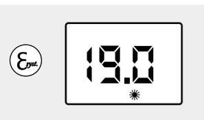
L'appareil se positionne en mode auto, les fonctions à économie d'énergie sont activées et les températures de Confort et ECO reviennent aux températures préconisées de  $19^{\circ}\text{C}$  pour le confort et  $15,5^{\circ}\text{C}$  pour l'ECO.
