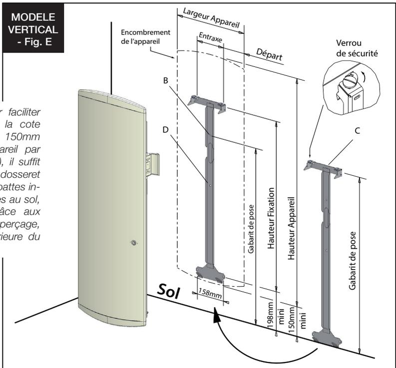
**NOTA :** Pour un meilleur maintien de l'appareil au mur, il est possible de rajouter 1 vis de fixation sur le montant du dossier (Rep. D Fig. E).
