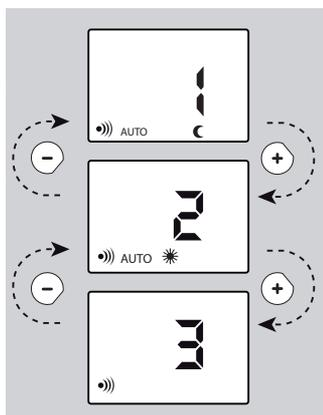
En mode veille (écran éteint), appuyer pendant 10 secondes simultanément sur et sur jusqu'à ce que s'affiche l'option de détection 1, 2 ou 3.
