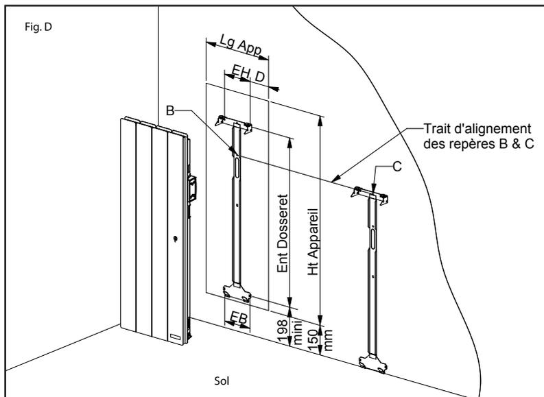
**NOTA :** Pour un meilleur maintien de l'appareil au mur, il est possible de rajouter 1 vis de fixation sur le montant du dosseret (Rep. D Fig. D).
