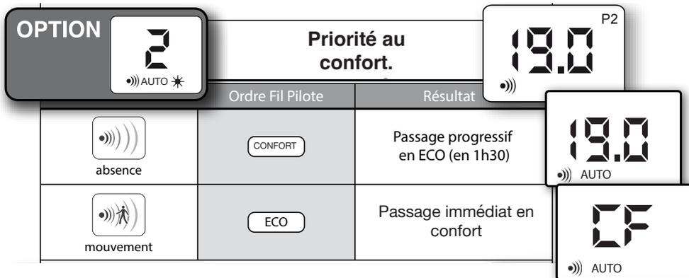
*i* Passage progressif en ECO : En cas d'absence prolongée, la consigne de température de l'appareil diminue progressivement par paliers de 30min en CF-1 puis CF-2, jusqu'à l'affichage d'ECO.
