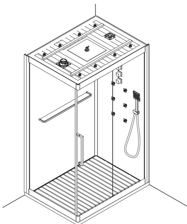
Vous avez la possibilité de réaliser un montage sans réhausse («jupe» fournie systématiquement). Dans ce cas, assurez-vous d'avoir un sol préparé, adapté à la pose de votre receveur et une évacuation optimale. Ce type de pose est plus difficile à mettre en oeuvre, ne vous lancez pas dans ce type de pose sans vous être préalablement assuré de remplir les conditions ci-dessous.
