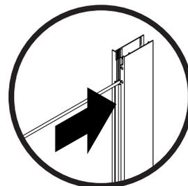
Vérifiez ensuite l'espace nécessaire au montage des traverses horizontales, la paroi de verre doit être centrée sur la hauteur (voir schémas ci-dessous), dans le cas contraire, ajustez la position à l'aide d'un maillet caoutchouc:
