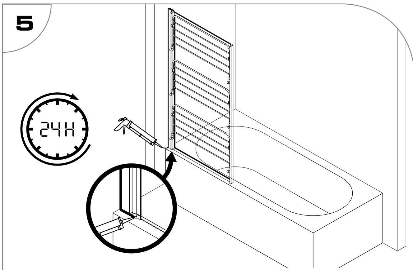
Afin d'assurer une étanchéité totale, nous conseillons de siliconer la jonction extérieure entre le mur et le profilé sur toute sa hauteur. Utiliser du silicone sanitaire bactéricide et fongicide afin de garantir sa tenue dans le temps.
