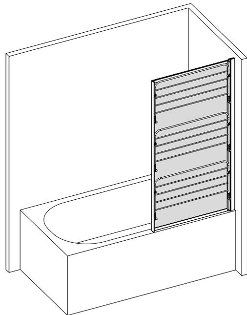
Vous avez la possibilité de réaliser un montage à gauche ou un montage à droite. Nos instructions de montage décrivent un montage à gauche. Si vous voulez réaliser un montage à droite, il vous suffit d'inverser le montage.
