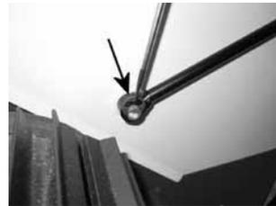
3 - Clipper le jonc d'arrêt dans la rainure de l'axe.
