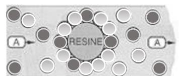
**Etape 4 :** La résine est régénérée avec de la saumure permettant de la débarrasser du calcaire de la résine pour l'évacuer à l'égout.
