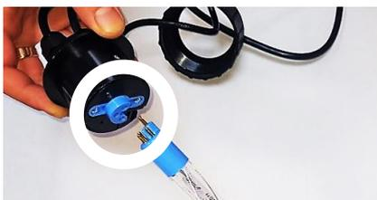
**N°3** : Brancher le haut de la lampe sur la tulipe de connexion, les picots mâles de la lampe doivent rentrer dans les trous de la tulipe de connexion prévue au branchement de la lampe.
