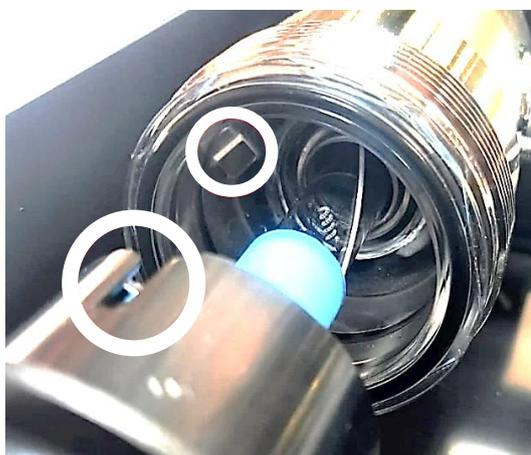
**N°4** : Présenter l'ensemble raccordé bien à la verticale dans le centre de la chambre en inox de la partie UVc et descendre cet ensemble doucement jusqu'au fond. La lampe doit rester branchée à sa connexion.
