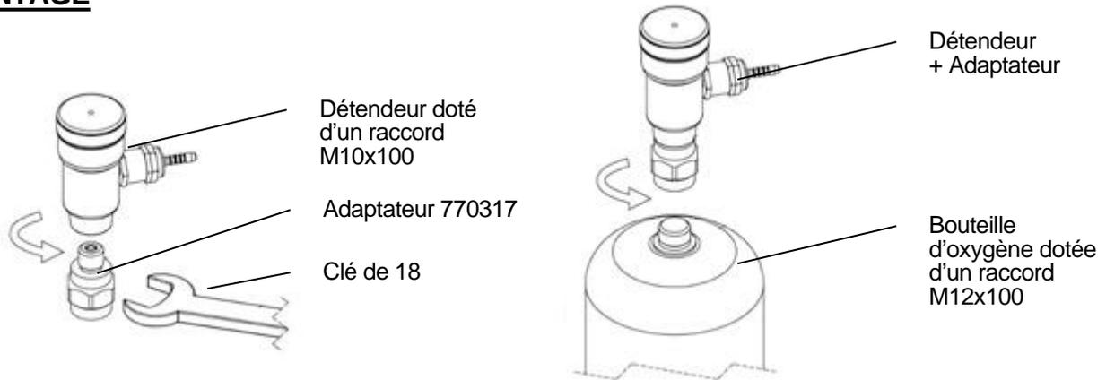
1. Connectez l'adaptateur au détendeur oxygène en le vissant dans le sens horaire. Prenez le soin de le serrer à l'aide d'une clé de 18.
