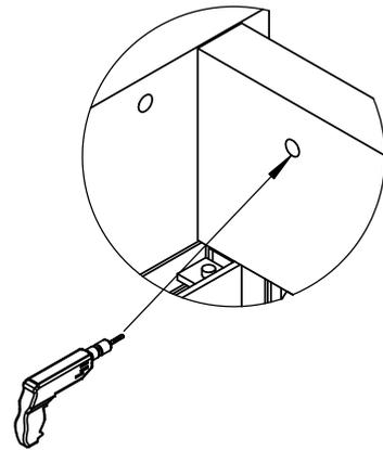
**4** Fixation des 2 perçages traverse
