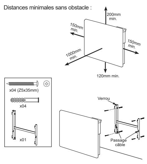
Les vis et chevilles fournies sont adaptées pour des supports de type plein. Pour tout autre type de support, veuillez utiliser les vis et chevilles adaptées.
