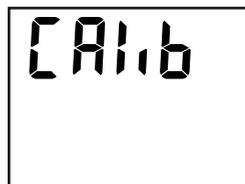
*Par exemple, si l'appareil est réglé à 20° et si le thermomètre ambiant affiche 18°, le calibrage doit être de -2°.*
