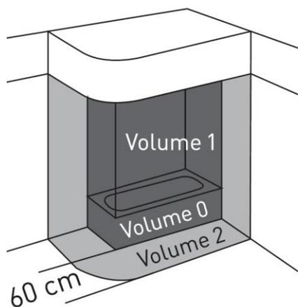
**Avertissement:** cet appareil doit être installé uniquement dans le hors volume d'une salle de bain conformément aux exigences de la norme française d'installation électrique NF C 15-100.
