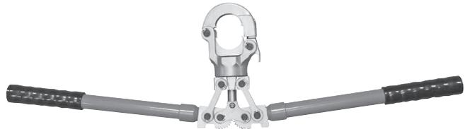
3. Faites pivoter la tête de la pince jusqu'à ce que l'orifice de la base de la tête tombe en face de la vis de serrage.
