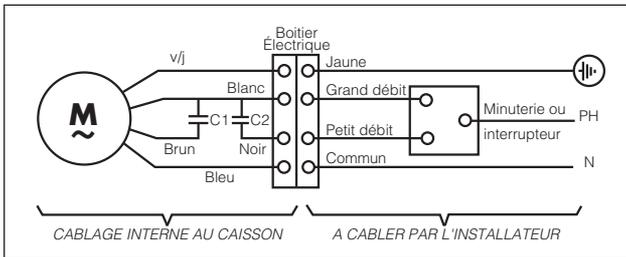
NOTA : prévoir un fusible au tableau général. Intensité de protection adaptée à la motorisation (voir plaque signalétique).
