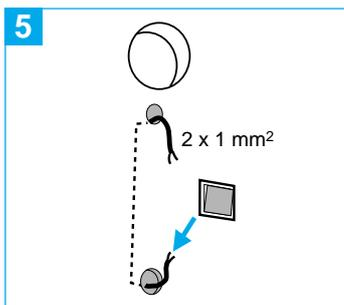
5 Passer les fils électriques (2 x 0,5 à 1 mm<sup>2</sup>) dans la cloison et sceller le boîtier de réservation.
