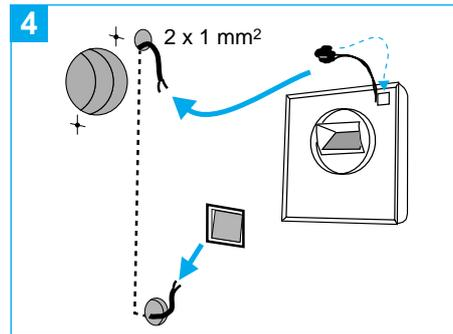
Passer les fils électriques (2 x 0,5 à 1 mm<sup>2</sup>) dans la cloison et sceller le boîtier de réservation.
