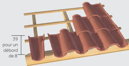
La finition d'égout avec tuiles courant/couvert permet une réalisation irréprochable pour les toitures qui n'utilisent pas de gouttière. Elle est retenue en tête par un liteau intermédiaire.
