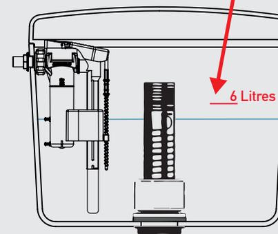
Afin de régler la quantité d'eau dans le réservoir, ajustez la hauteur du godet en **visant (+d'eau) / dévissant (- d'eau)** la tige jaune. Tirez la chasse puis laissez le réservoir se remplir. Renouvelez l'opération jusqu'à l'obtention du bon volume.
