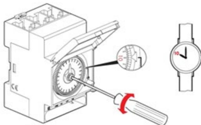
Figure 58 – Réglage de l'heure sur l'horloge de filtration
