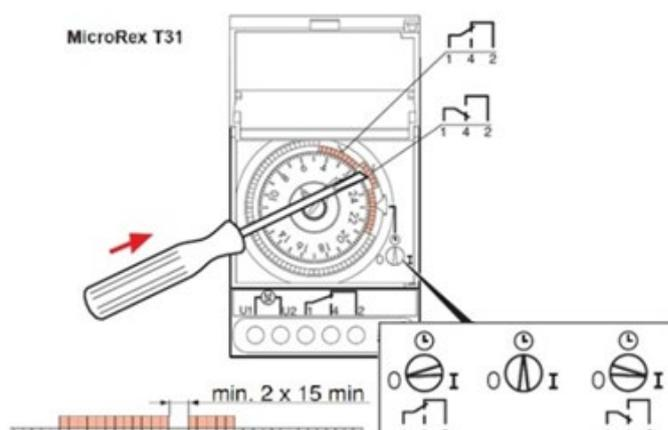
Figure 59 – Programmation automatique de la filtration
