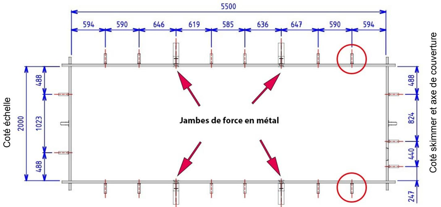
Figure 15 – Emplacement des consoles de margelles
