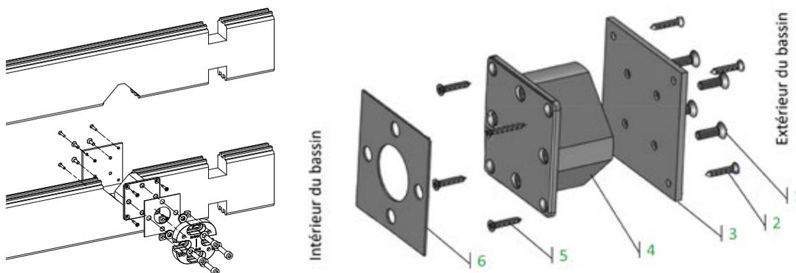
Figure 28 – Montage du support de palier
