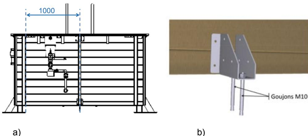
Figure 13 – a et b - Pose des sabots pour jambe de force en bois
