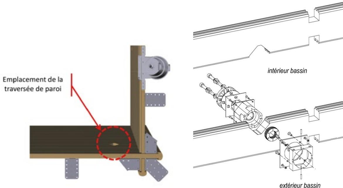
Figure 26 – Emplacement de la traversée de paroi
