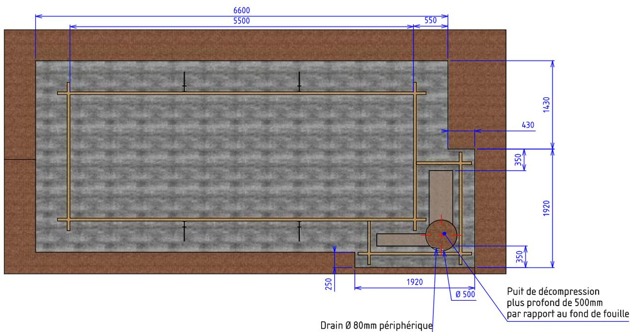
Figure 1 – Plan de pose du système de drainage
