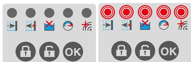
Quand les 5 LEDs clignotent, appuyez sur la touche OK pendant 1 seconde. Les deux LEDs de gauche s'allument.
