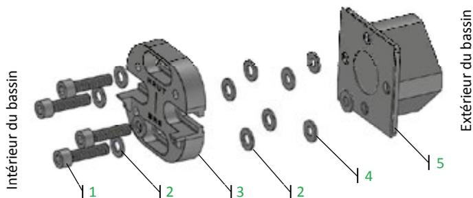
Figure 37 – Montage de la bride porte-palier
