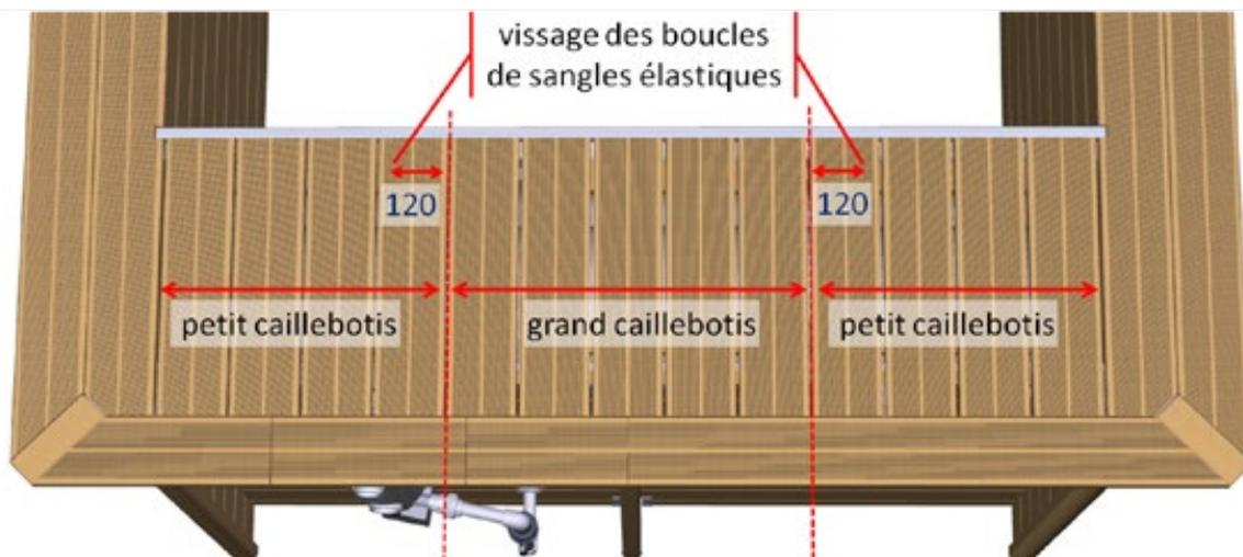
Figure 53 – Fixation des sangles élastiques sous les caillebotis
