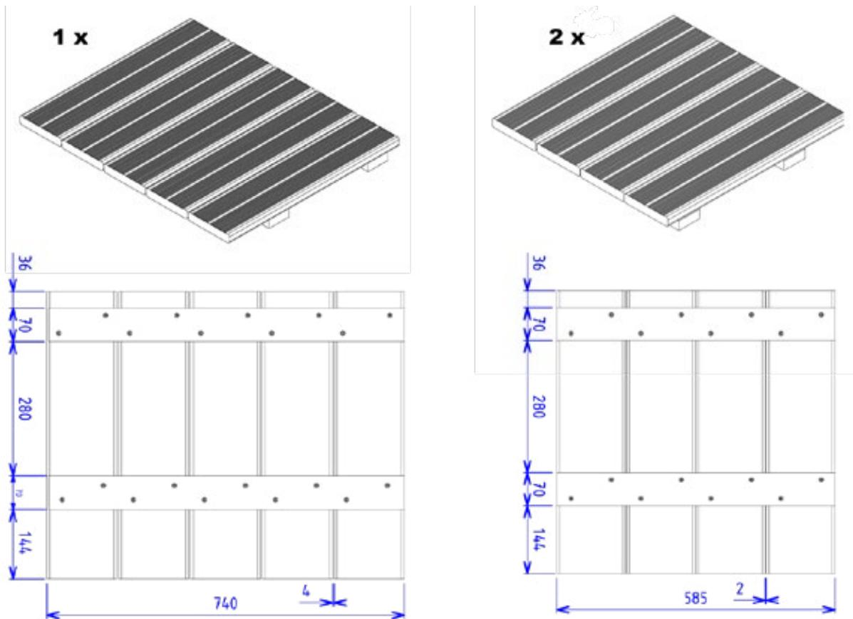
Figure 52 – Assemblage des caillebotis
