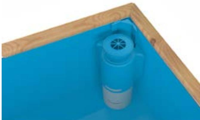
Plaquer les ventouses contre le liner pour maintenir le filtre en place. Si le filtre à tendance à basculer et à remonter, s'assurer qu'il ne contient pas de bulle d'air, et ajouter éventuellement quelques centimètres d'eau dans la TROPIC JUNIOR.
