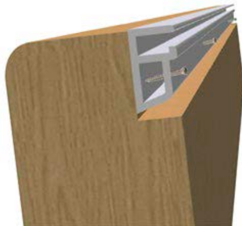
Figure 18 – Pose du rail d'accrochage
