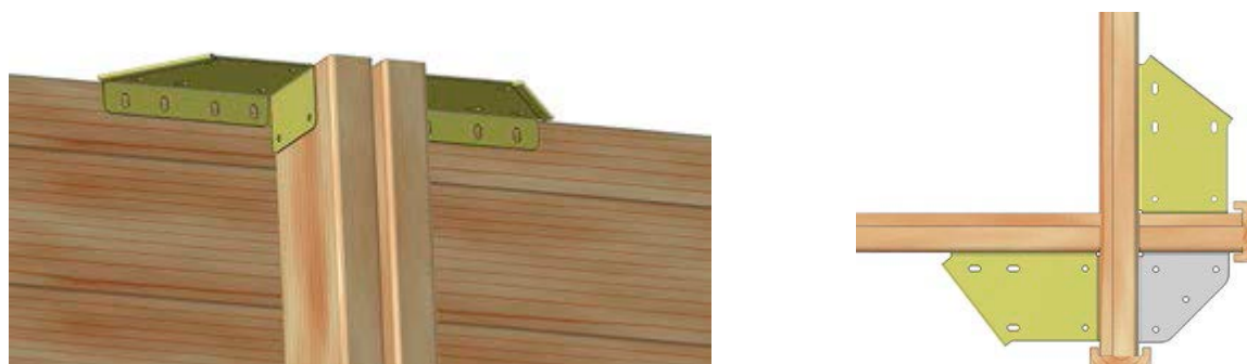
Figure 13 – Mise en place des équerres de margelles en haut des jambes de force et dans les angles
