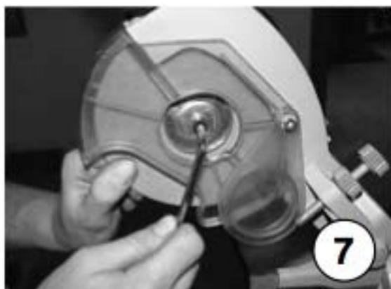
Ne serrez pas les vis trop fort, vous pourriez endommager le disque abrasif. Le couple de serrage du disque abrasif sur le moyeu fait 7Nm. Pour plus de précision, utilisez une clé dynamométrique (image 7).
