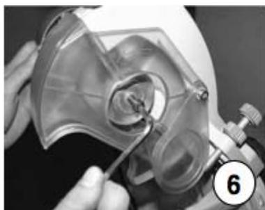
Fixez la manette du bras de support sur la vis placée dans le corps de la lame de scie.
