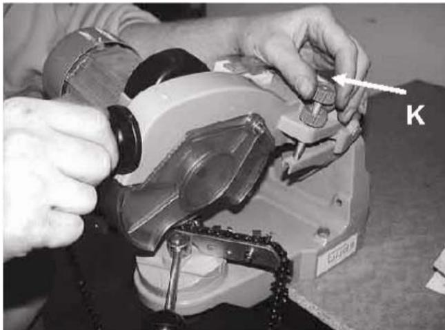
Après le réglage correct de l'étau, de l'angle de tranchant et un préréglage de l'angle de sommet, dirigez prudemment le disque abrasif à l'aide de la poignée (#1) en haut du levier vers la dent. Vous pouvez régler la profondeur de l'affûtage à l'aide de la vis d'arrêt (K).
