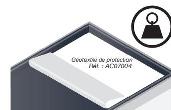
Dans le cas d'un lestage, pas de collage horizontal, mais pose d'un géotextile de protection.
