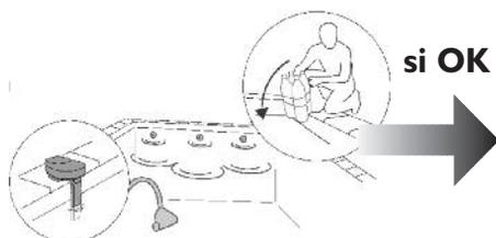
Filtration et robot en marche, du point le plus éloigné de votre appareil, faites chuter du haut de la margelle le poids de 6 kg. La sirène doit retentir 12 secondes maximum après la chute.
