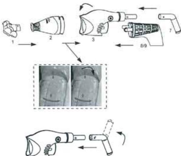
La flèche sur le couvercle transparent avant doit être alignée sur la flèche du corps de l'appareil. Il faut ensuite effectuer une rotation à 90° pour ouvrir ou fermer. Il faut bien positionner au fond le couvercle transparent sur l'intérieur du corps de l'appareil.
