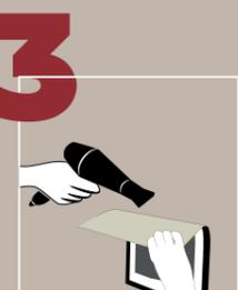
Pour plus de facilité, utiliser un sèche-cheveux pour chauffer les Vinyl Way. Respecter une distance de 10cm.
