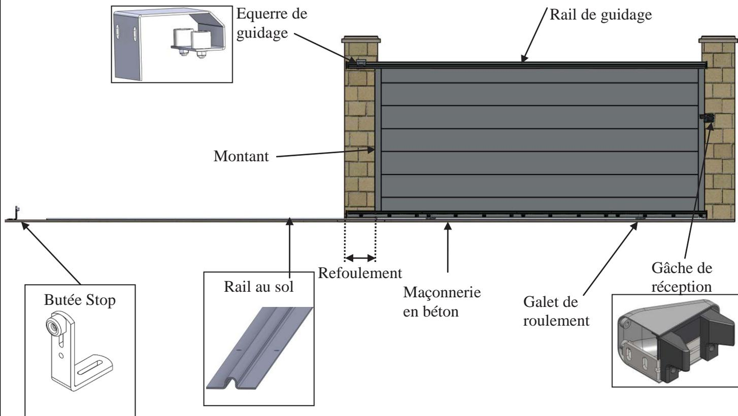
*Exemple d'un portail coulissant à gauche vu de l'intérieur (soit un portail commandé en coulissant à droite vu de l'extérieur)*
