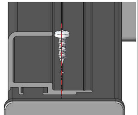
Positionner la vis dans axe rainure
