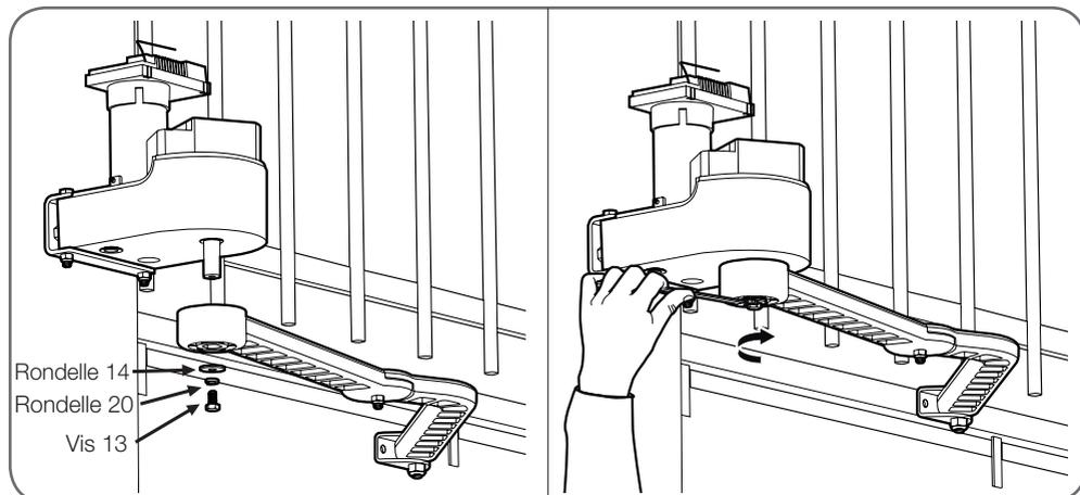
Débrayage du moteur :
