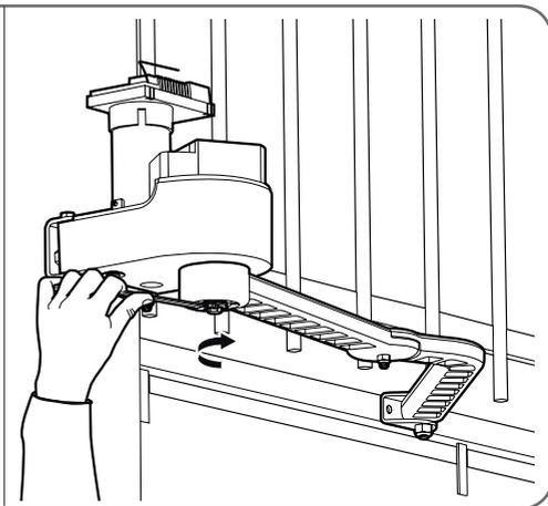
Débrayage du moteur :
