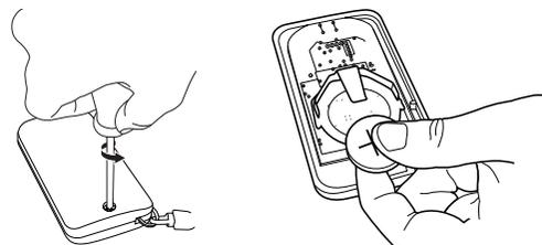
La télécommande est alimentée par une pile bouton de type CR2032. Retirez l'ancienne pile et insérez la nouvelle en respectant la polarité indiquée.
