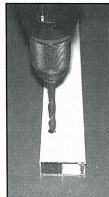
Perçer au diamètre 5 les coulisses (5 trous répartis par coulisse, voir croquis ci-dessous) et perçer la partie supérieure à 10mm pour permettre le passage du tournevis et de la tête de vis
