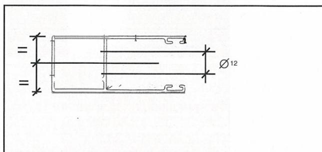
Faites un premier essai de serrure. Ajuster éventuellement le trou avec une lime "queue de rat" de façon à ce que le penne de la serrure se place correctement sans à coup dans la serrure.
