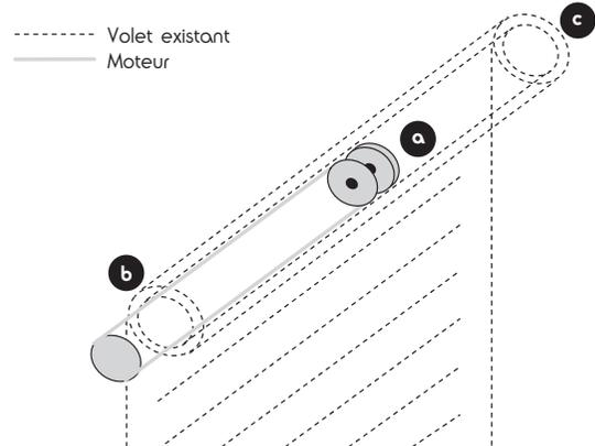
Le moteur tubulaire est fixe, seule l'extrémité du moteur « a » entraîne en rotation le tube du volet. L'extrémité du moteur « b » comporte une bague de guidage (son mouvement est libre, ce n'est pas le moteur qui l'entraîne), de manière à remplacer le guidage d'origine du volet. Le guidage en rotation du tube « c » est conservé tel quel.
