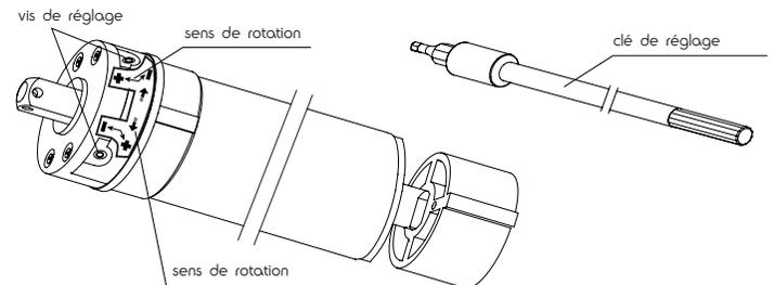
En tournant la clé de réglage dans le sens des aiguilles d'une montre, on augmente la distance parcourue par le volet. En tournant la clé de réglage dans le sens contraire des aiguilles d'une montre, on diminue la distance parcourue par le volet. La couleur de la vis à utiliser (rouge ou blanche) pour la butée haute ou basse dépend du sens de montage du volet et du sens d'enroulement du volet ou du store :
