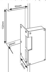
Vérifiez que la distance entre la porte et la gâche électrique est comprise entre 3 et 5 mm.
