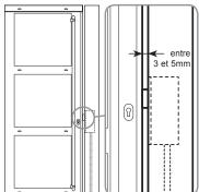
**Attention :** en position porte fermée le téton de la gâche doit être enfoncé par le pêne de la porte.
