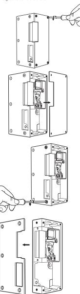
Si vous êtes dans le cas d'un montage avec gâche côté gauche, démontez puis descendez le bloc mécanique.
