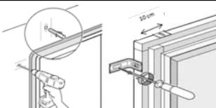
Une fois le cadre posé, vérifier l'aplomb et les diagonales. Rectifier si nécessaire. Fixer définitivement et remettre les vantaux en place. Un réglage peut parfois être nécessaire pour rectifier 1 ou 2 mm (tolérance acceptable de pose)
