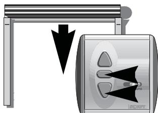
Appuyer simultanément sur les touches stop et descente jusqu'à ce que le volet roulant descende (3s).
