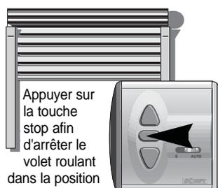
Appuyer sur la touche stop afin d'arrêter le volet roulant dans la position intermédiaire souhaitée (Si nécessaire, appuyer sur ▲ ou ▼).
