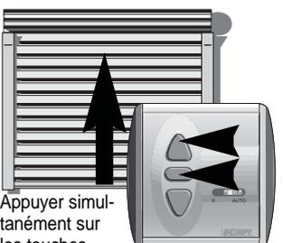
Appuyer simultanément sur les touches stop et montée jusqu'à ce que le volet roulant monte (3s).
