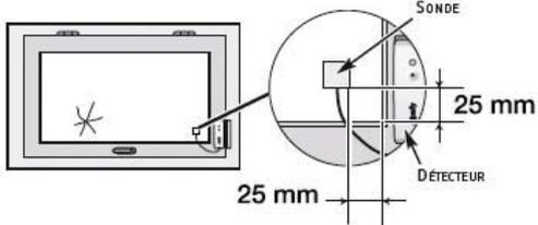
Il détecte l'ouverture d'une fenêtre, la vibration exercée sur la vitre lors d'une tentative d'intrusion et le bris de cette vitre.
