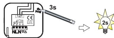
[3]. Appuyez avec un objet fin sur le bouton PROG au dos de la télécommande ou de la commande murale sans fil. L'éclairage s'allume pendant deux secondes.
