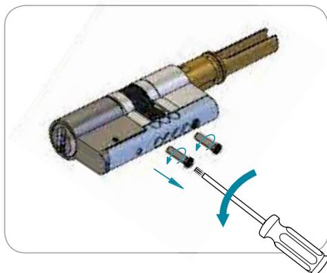
En fonction de la configuration à obtenir, utilisez le tournevis T-10 fourni pour dévisser la vis de fixation située sous la partie métallique P2 ou P3.
