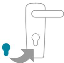
Votre serrure connectée contient un nouveau cylindre (réglable) qui vient remplacer celui actuellement installé dans la porte.
