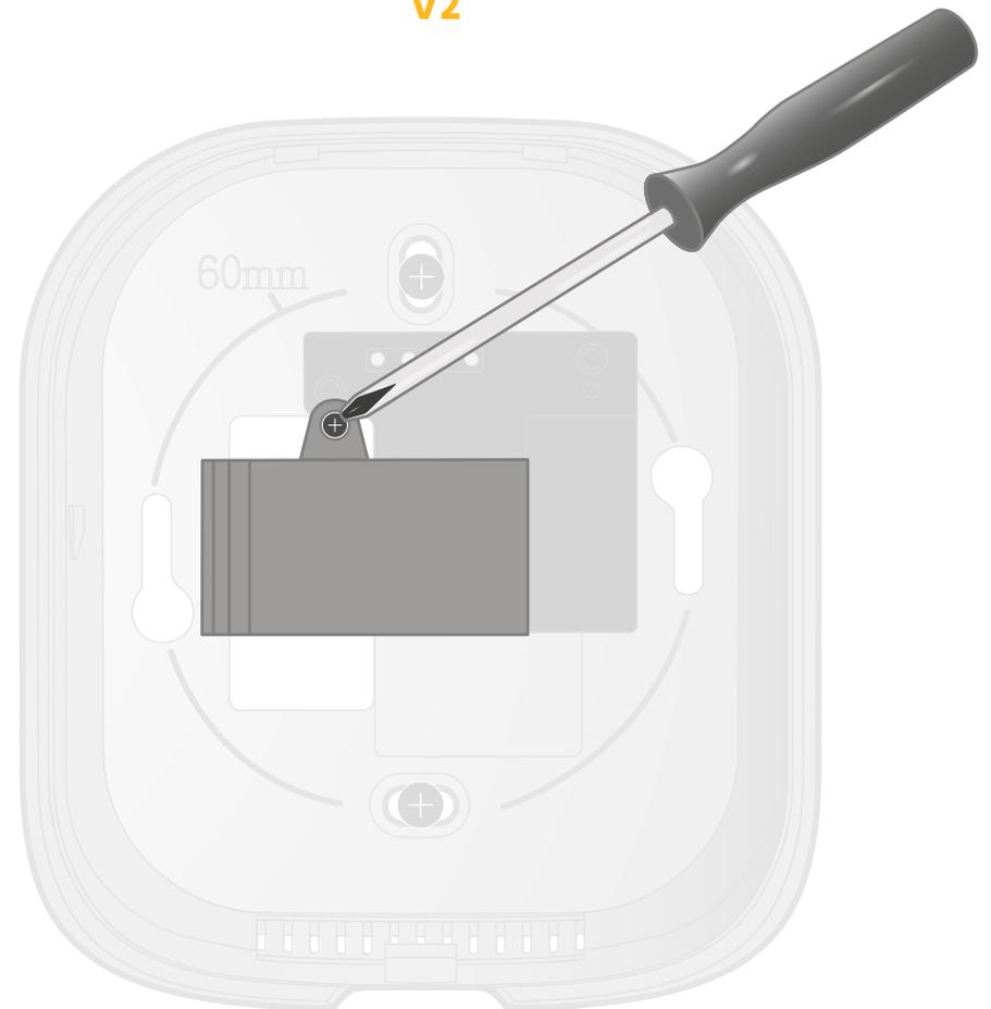
Sur la partie arrière, écartez les pattes de fixation et tirez le cache vers le bas pour accéder au bornier.
