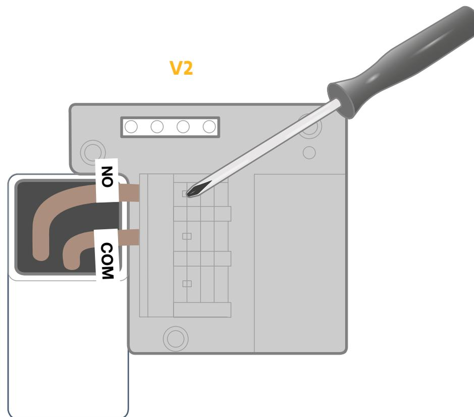
Insérez et clippez les câbles sur les sorties NO & COM du bornier à clip automatique (pas de polarité).
