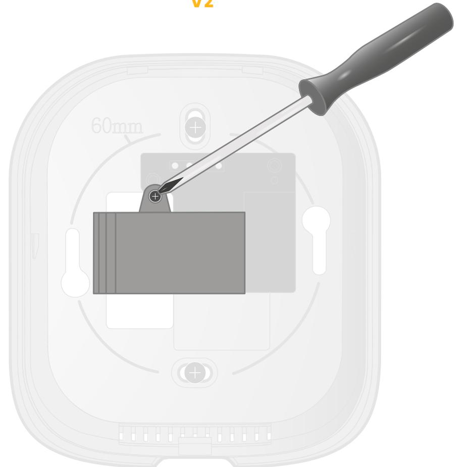
Repoussez l'excédent de fil dans le mur et replacez le cache-bornier.
