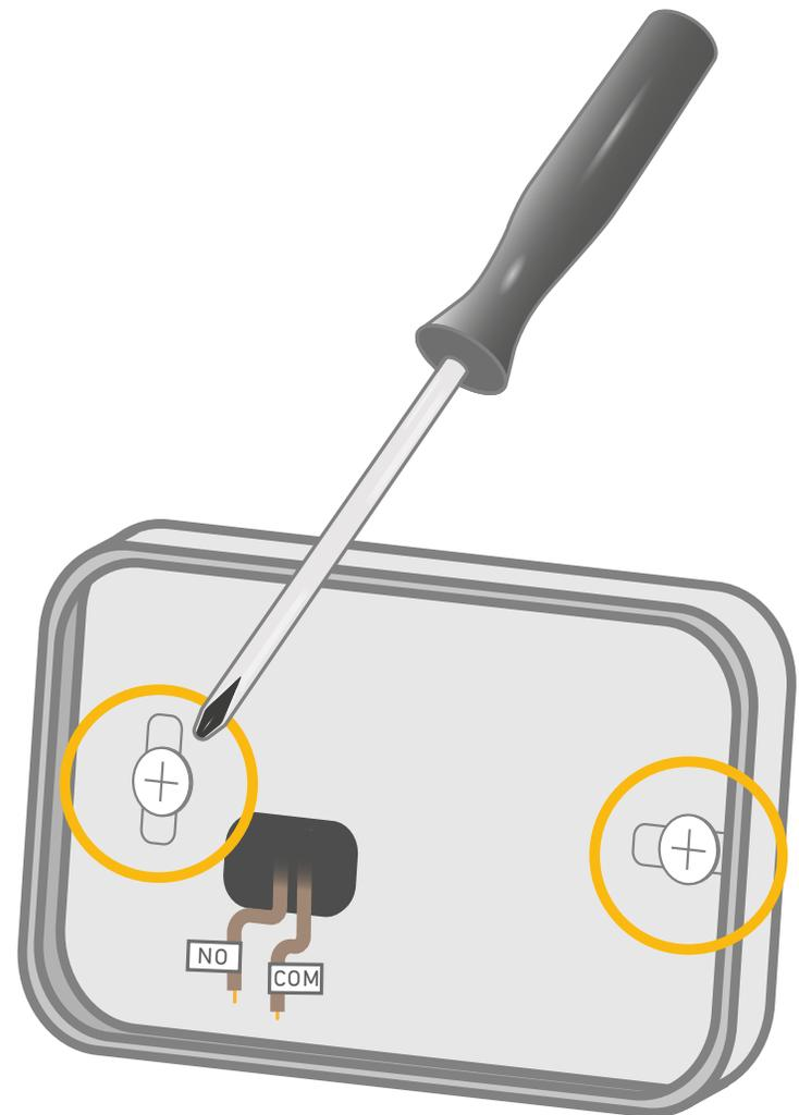
Finissez la désinstallation en dévissant la face arrière qui supporte le bornier.
