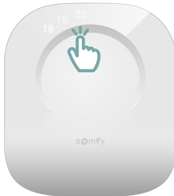
Réveillez votre thermostat en touchant la surface tactile. Les chiffres apparaîtront et la gateway passera au vert fixe.
