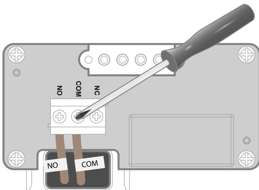
Raccordez les câbles aux bornes respectives NO & COM et vissez pour les sécuriser (pas de polarité).
