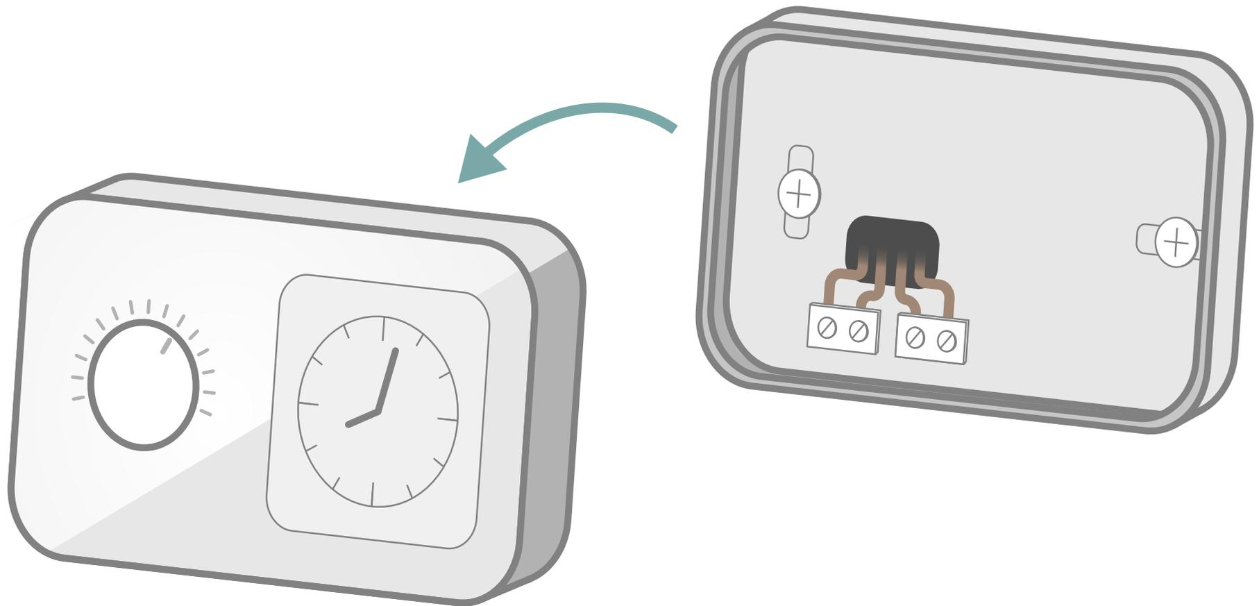
En fonction du modèle de votre thermostat, dévissez ou déclipsez la face avant.
