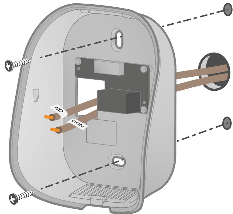
Fixez la face arrière au mur avec les accessoires fournis tels que vis et chevilles. Vous pouvez aussi coller le thermostat avec les adhésifs fournis.
