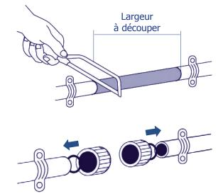
**CPED** préconise le montage du **PILOTEPHOS REVOLUTION** à l'aide de flexibles en amont et en aval afin d'éviter d'éventuels dégâts suite à des « coups de bélier ».
