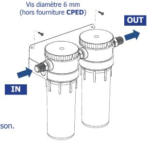
Fixer solidement l'équerre par l'intermédiaire de 2 vis (non fournies) d'un diamètre de 5 millimètres adaptées au support de pose de l'équerre du **PILOTEPHOS REVOLUTION** (briques, cloison de plâtre, Etc.).
