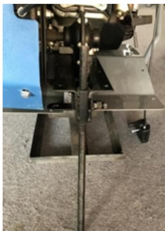
Connecter le set le lame et le disque arrière avec les vis et les écrous M10. Mettre ensuite le jeu de lame à l'arbre du réducteur. Serrer les vis M10x45 et les écrous M10. (Veuillez vous assurer que la partie coupante de la lame se trouve face à la roue avant).
