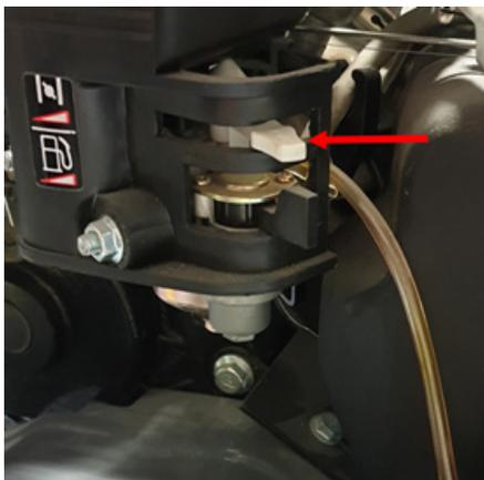
Laisser tourner le moteur quelques secondes en position starter fermé et basculer en position ouvert.
