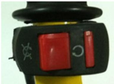
S'assurer que l'interrupteur d'arrêt est en position Marche avant de démarrer le moteur. S'assurer que l'interrupteur d'arrêt est en position Arrêt pour arrêter le moteur.
