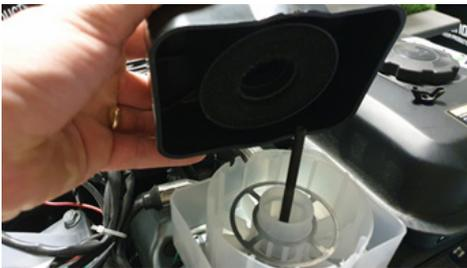
Mettre de l'huile moteur jusqu'au niveau maximum.
