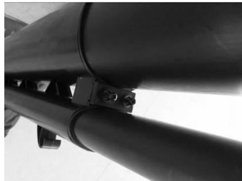
Montez les roues sur le tube inférieur. Ajoutez une roue de chaque côté du trou située sur le tube inférieur le plus petit. Fixez les roues avec la vis et l'écrou. Ensuite, fixez les deux plaques et les vis pour fixer les tubes ensemble.
