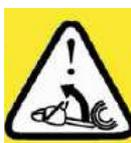
Le contact de l'extrémité du guide-chaîne avec tout objet doit être évité.
