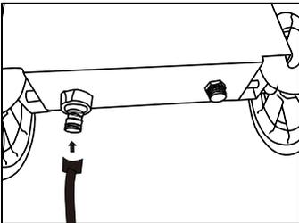
Étape 5: connectez le tuyau d'alimentation d'eau au raccord d'entrée d'eau du nettoyeur.
