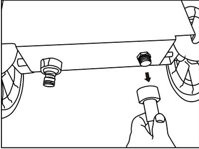
5. Déconnecter le flexible d'eau haute pression du raccord de sortie d'eau du nettoyeur.
