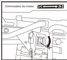
1. Mettre l'interrupteur du moteur sur le bouton "OFF"
