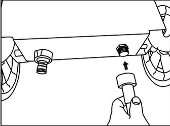
Étape 4: Connecter le flexible au raccord de sortie d'eau du nettoyeur haute pression.
