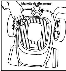
7. Tirez d'abord doucement la poignée du lanceur jusqu'à la butée, ensuite tirer d'un coup sec pour lancer le moteur.
