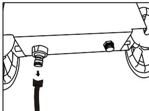
4. Déconnecter le flexible d'entrée d'eau du raccord d'entrée d'eau du nettoyeur.
