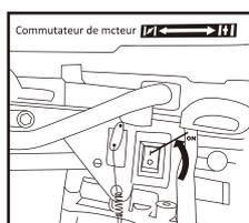
6. Mettre l'interrupteur de l'appareil sur "ON"
