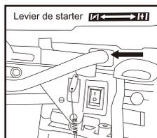
5. Mettre le levier de starter sur la position "ON"
