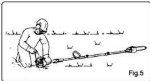
3. Appuyez 5 à 8 fois sur la poire d'amorçage jusqu'à ce que du carburant s'écoule à travers la durite transparente.
