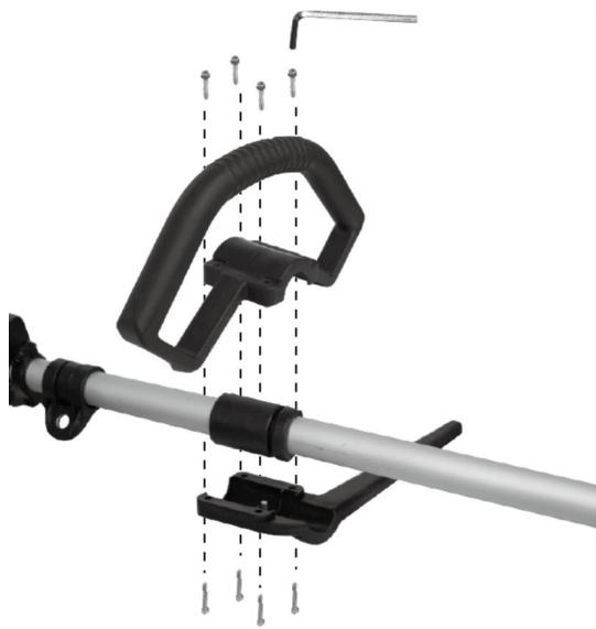
Installez la poignée avant comme indiqué sur l'image ci-dessous. Veillez à orienter la tige en direction du trou. Ne pas fixer les vis avant d'avoir réglé la position de travail la plus agréable à l'aide des sangles. La poignée avant doit être orientée comme indiqué sur l'image:
